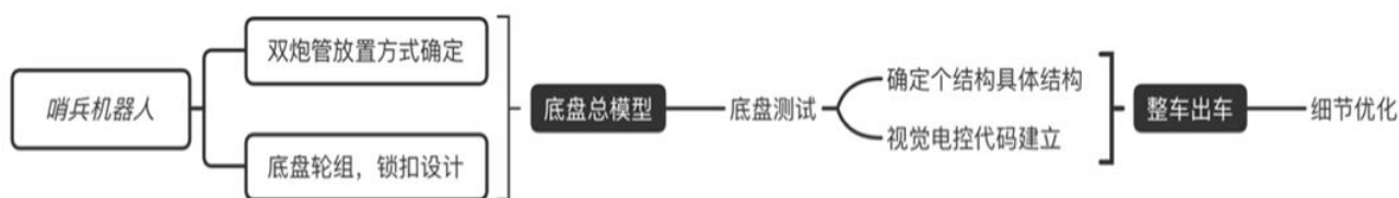
图 2-3-2 下双发射哨兵机器人设计思路
